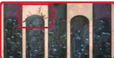
标准免清洗锡膏 显示出有问题的晶枝生长
